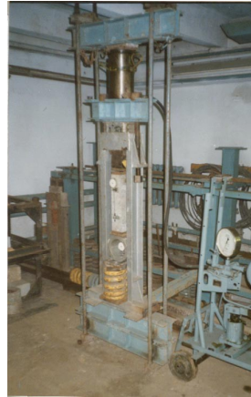
Рис. 1. Стенд для випробовування бетонних призм тривалим навантаженням: 1 – рама силової установки; 2 – пружини; 3 – кільцевий динамометр, 4 – призма; 5 – кульковий шарнір; 6 – фіксувальні тяжі; 7 – п'ята для передачі навантаження, 8 – розподільча траверса.
